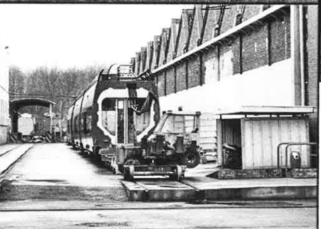
Un engin rail-route prêt à manoeuvrer un segment d'AGC en finition au sein de l'usine Bombardier (ex-ANF) de Crespin (F), le 20 novembre 2008 (photo Philippe Armand).
